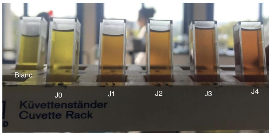
Figure 2: Photo de la gamme étalon obtenue avec le DNS
